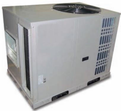
Unidades compactas frío calor con capacidades desde 5 Ton hasta 30 Ton de refrigeración. Cuentan con doble circuito de refrigeración, compresores del tipo Scroll que proveen máxima eficiencia con bajo nivel sonoro, línea refinada y formato pequeño, se adecuan a cualquier espacio, flujo de aire horizontal facilita su instalación y su diseño permite proteger el condensador contra eventuales daños.
