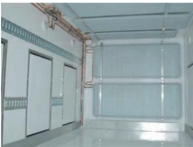
Carrocerías para transporte de helados fabricadas en paneles de poliuretano de alta densidad enchapados en fibra de vidrio. Disponibles en modelos de 2 a 5 puertas laterales por lado, con o sin puertas traseras. Equipo de frío en base a placas eutécticas, compresor/condensador para ser instalado sobre o bajo carrocería, temperatura de transporte -33°C.
