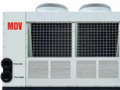
Nuestros chillers son refrigerados por aire, de diseño modular, adoptan la tecnología Digital Scroll que permite modular su capacidad de salida, en forma continua, desde 0,5 a 100%. Existen dos tipos de módulos: uno con compresor de capacidad variable y uno con compresor de capacidad fija. Capacidades de equipos 30 y 65 kw que en su combinación permiten una potencia máxima de 520 kw.
