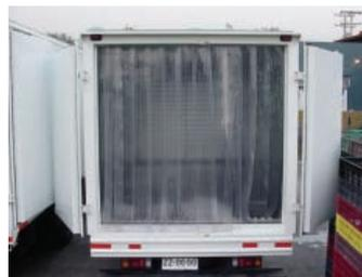
Aplicación Lama PVC fija en camión
